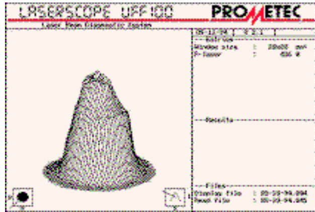
(d) Collimated beam from fiber.
